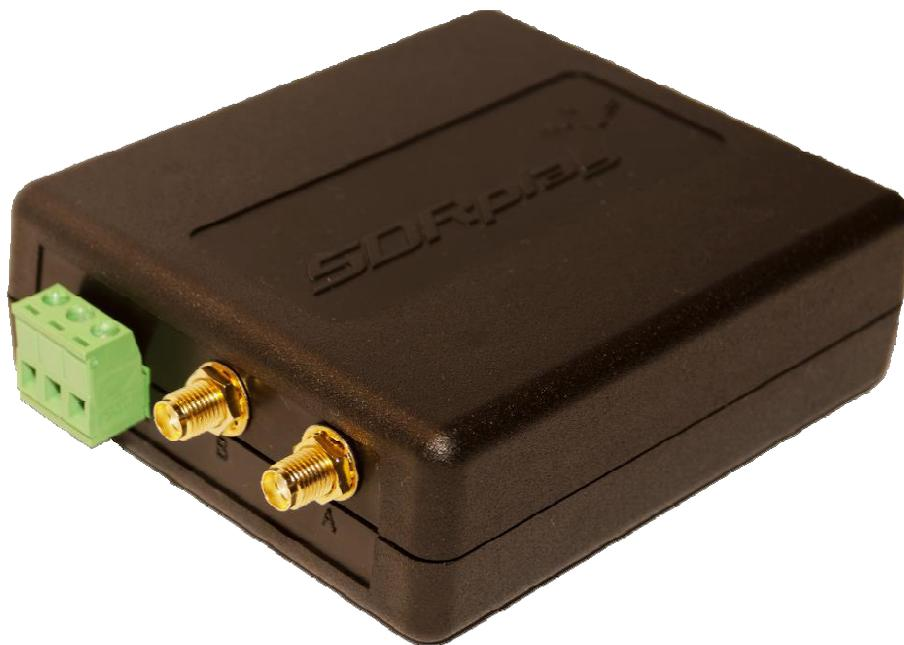
RSP2は、パワフルで1kHzから2GHzまでカバーする広帯域なSDR受信機です。RSP2は、RSP1にはなかった高安定度を持ったTCXOを装備しておりますが、更に外部クロック入出力端子を備えています。この端子を利用することにより、複数のRSP2をデジーチェーンで接続して局発を共有したり、外部クロックと接続して更に精度と安定度を向上したりすることも可能です。本ヒントでは、RSP2の外部クロックターミナルの使用方法を説明しています。
