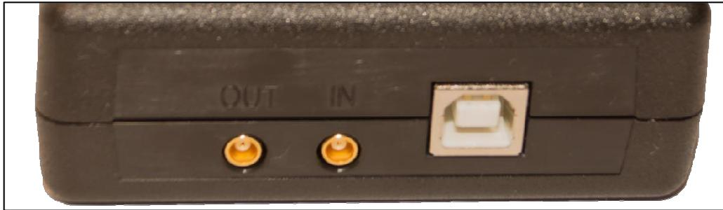
RSP2同士でクロックを接続する場合は、下図のようなMCX(オス)-MCX（オス）ケーブルが必要です。最初の1台がマスターで、それ以下はスレーブとしてOUT->IN-OUT->INと接続していくことが出来ます。
