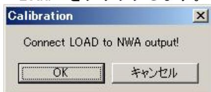
TX ポートに LOAD を接続後、「OK」ボタンをクリックします。
