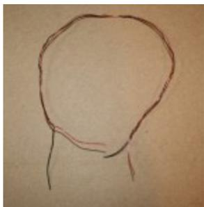
先程一次巻を完了したコア上に、同じ方向で二次を巻いて行きます。16回、巻いてください。(できるだけ等間隔で巻いてください。)
